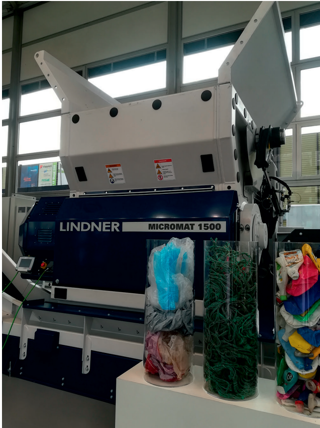
Bild 4. Micromat 1500: ein neues Modell im Bereich der stationären Universalzerkleinerer (© Lindner)
